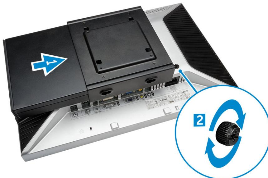
3. Deslice la funda del adaptador de alimentación a través de las ranuras situadas en la parte inferior del montaje de VESA doble para bloquearla.
